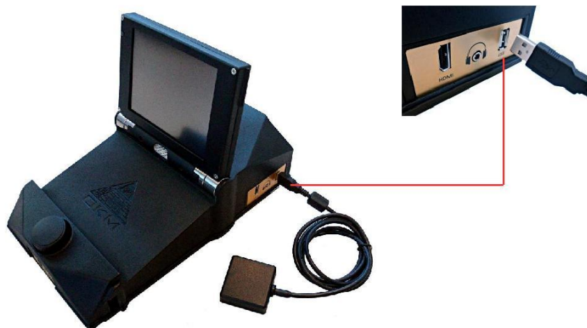
Figura 5.5: Conexión del receptor GPS externo
