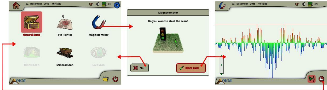
Figura 6.7: Flujo de trabajo del magnetómetro
