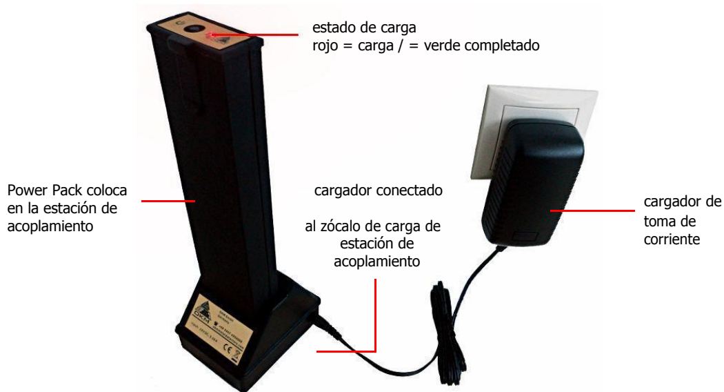
Figura 4.3: Carga de la unidad de alimentación
