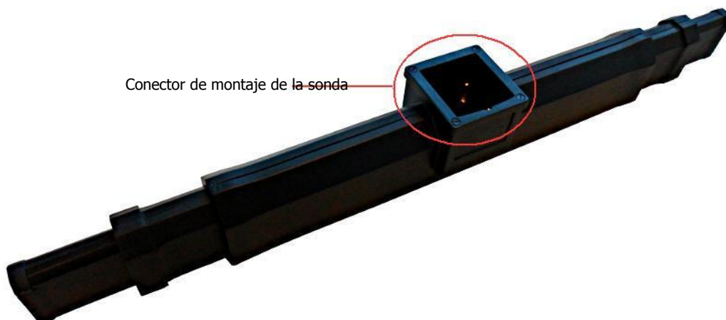
Figura 4.4: Elementos de control de la sonda telescópica
