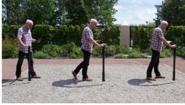
Şekil 7.7: «3D Ground Scan» modunda «Zikzak» tarama
