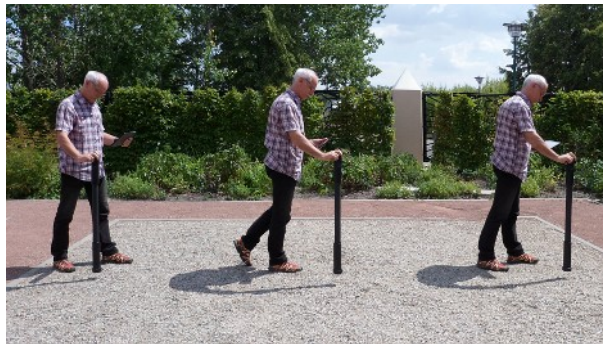
Figure 7.7: Balayage "Zig-Zag" en mode de fonctionnement "3D Ground Scan"
